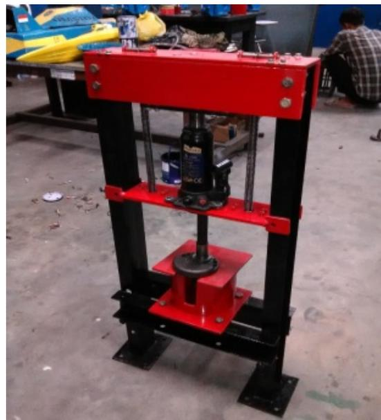
**Gambar 4. Alat Hidrolis Untuk Overhaul Part Crankshaft Sepeda Motor**
